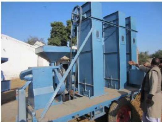
रक्सौल में निर्मित ट्रैक्टर टॉप मिनी राइस मिल
